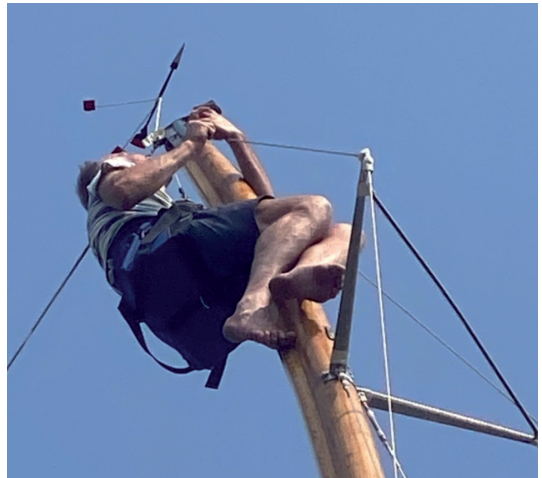
Mastarbete på hög höjd från båtsmansstolen efter det att storfallet återigen fungerade. Alla utom utförare tycket det var lika bra att "passa på" och åka upp ännu en gång för att se om Windexen skulle kunna repareras. Foto Ulf Aronsson.
