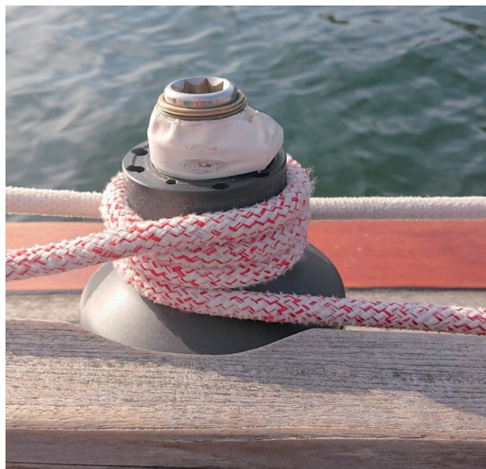
Den trasiga vinschen lagad med en slangklämma täckt med isoleringstejp.
